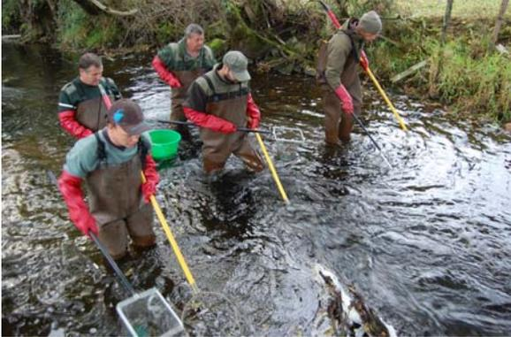
Dans un rayon d'action de 1 m autour de l'anode, des lignes électriques équipotentielles sont créés et ressenties par le poisson. La différence de potentiel entre la tête et la queue actionne les muscles du poisson qui adopte alors un comportement de nage forcée en direction de l'anode (zone d'attraction). A proximité de l'anode, ses muscles sont alors tétanisés ce qui rend le poisson capturable à l'épuisette (zone de galvanotaxie).
