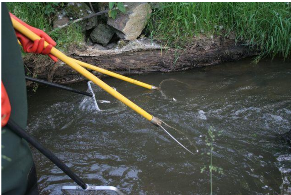
Photographie 15. Opération de pêche électrique
