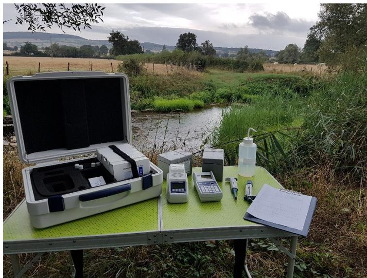
PHOTOGRAPHIE 1 : PHOTOMETRE PF12-PLUS ET BLOC CHAUFFANT MACHEREY-NAGEL
