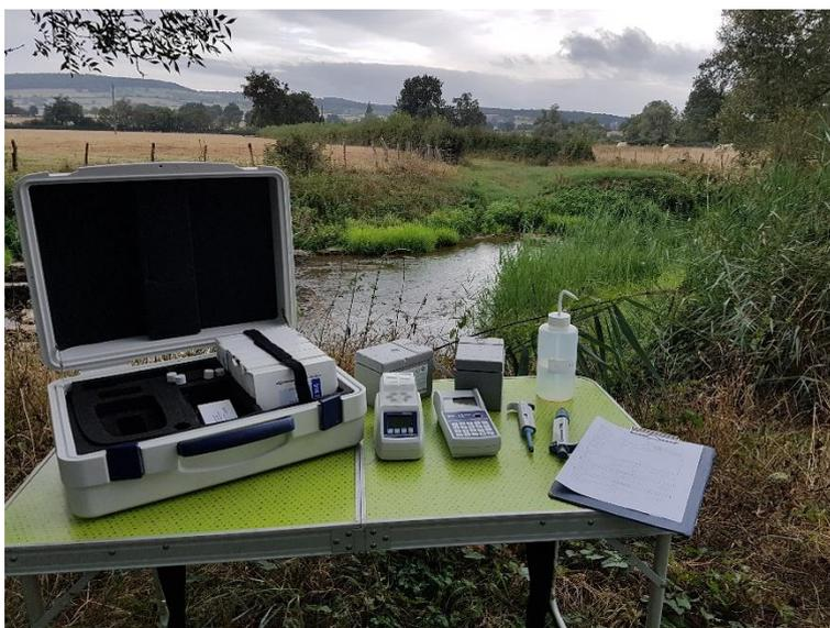
PHOTOGRAPHIE 1 : PHOTOMETRE PF12-PLUS ET BLOC CHAUFFANT MACHEREL-NAGEL
