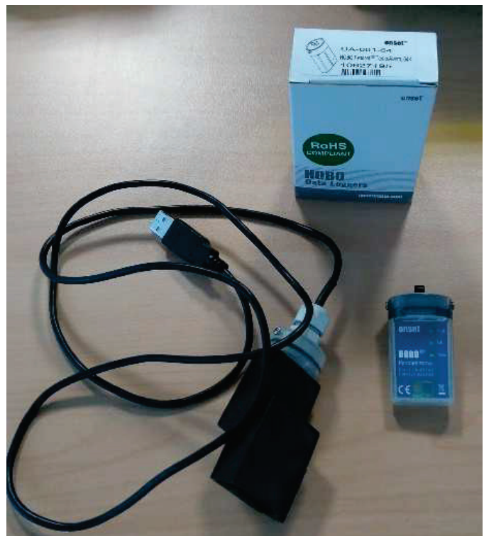
Photographie 1 : Matériel de suivi thermique.
