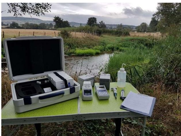
PHOTOGRAPHIE 3 : PHOTOMETRE PF12-PLUS ET BLOC CHAUFFANT MACHEREL-NAGEL
