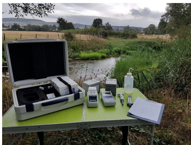
PHOTOGRAPHIE 3 : PHOTOMETRE PF12-PLUS ET BLOC CHAUFFANT MACHEREL-NAGEL
