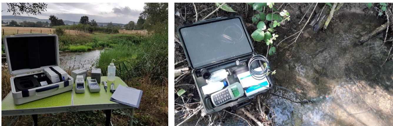
PHOTOGRAPHIE 1 : A GAUCHE, PHOTOMETRE PF12-PLUS ET BLOC CHAUFFANT MACHEREL-NAGEL ; A DROITE, MULTI PARAMETRE HI 98194 (HANNA INSTRUMENTS).
