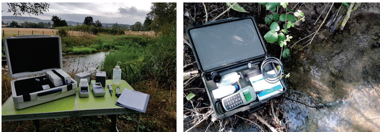
Photographie 1 : A gauche, photomètre PF12-Plus et Bloc chauffant MACHEREL-NAGEL ; à droite, multi-paramètre HI 98194 (HANNA Instruments).
