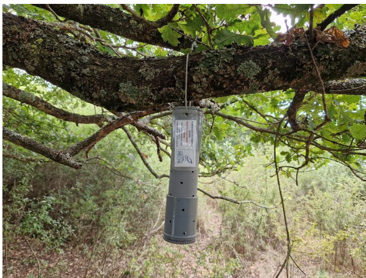
Photo 5 : Sonde mesurant la pression atmosphérique sur la zone d'étude, FD71
