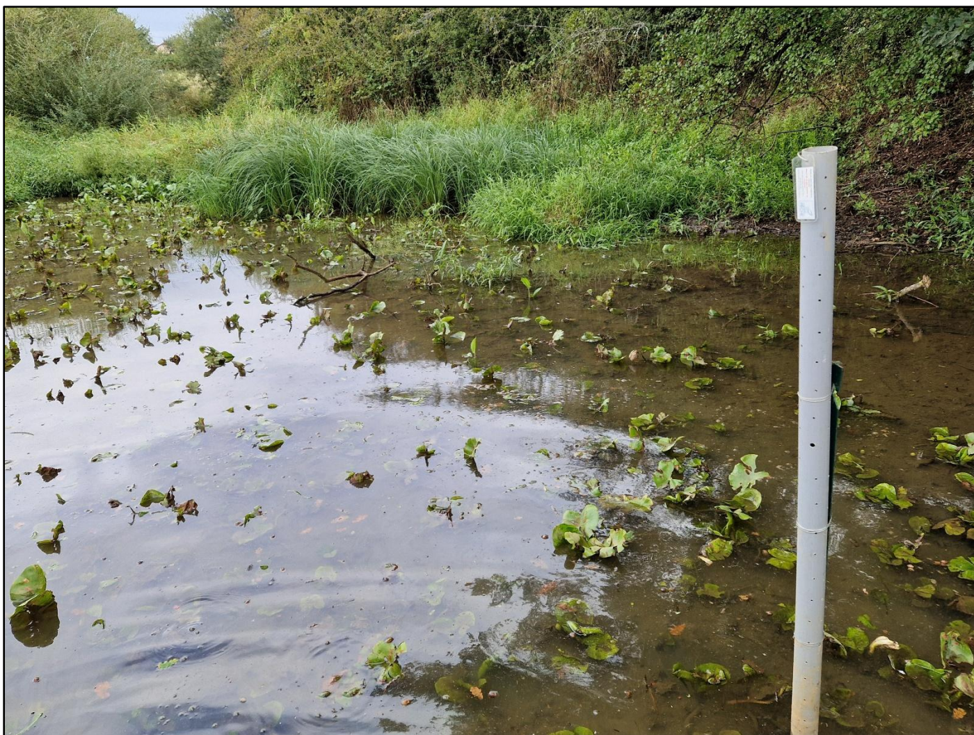
Photo 6 : Sonde mesurant la pression de l'eau sur la zone d'étude, FD71
