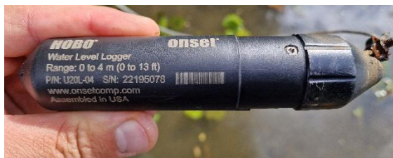
Photo 1 : Sonde de niveau d'eau, FD71
